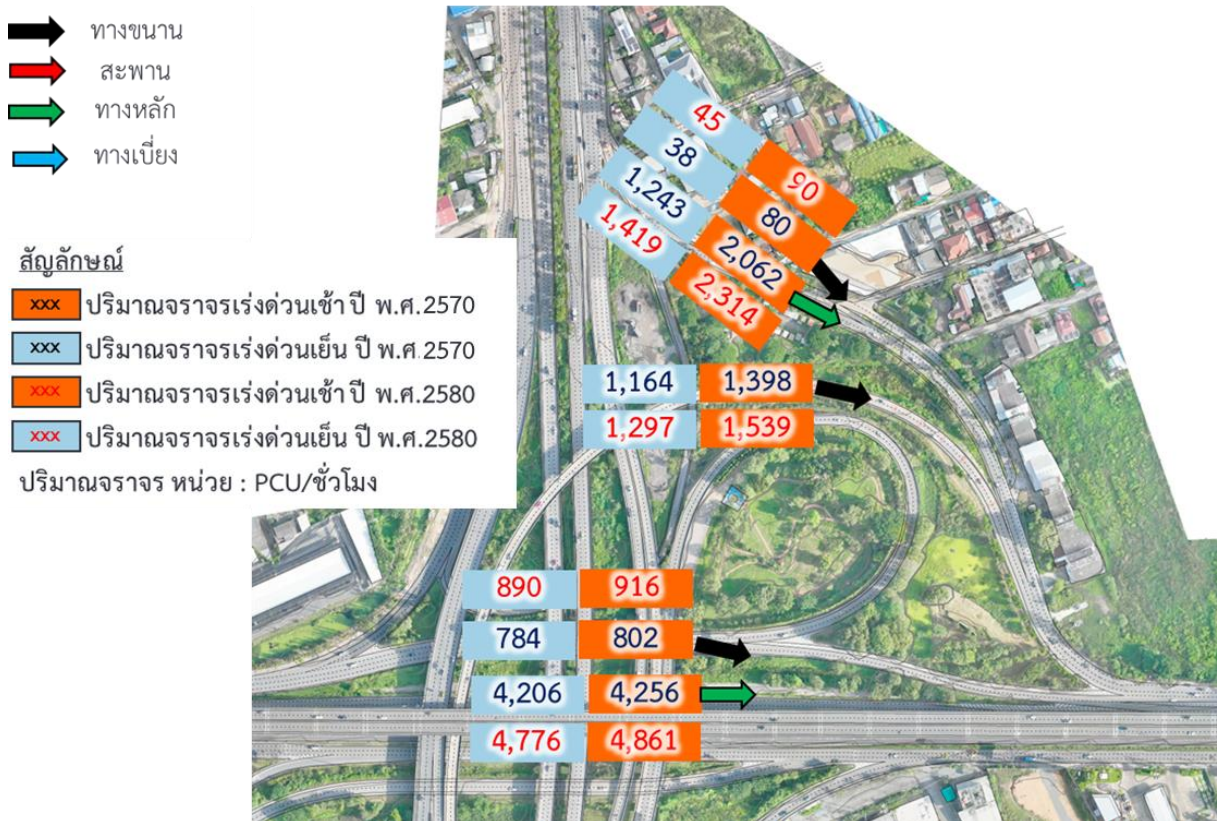
รูปที่ 10.2-6 ผลการคาดการณ์ปริมาณจราจรช่วงเวลาเร่งด่วนเช้าและเวลาเร่งด่วนเย็น (ปี พ.ศ. 2580) บริเวณ ทล.3902 เชื่อมกับ ทล.338
